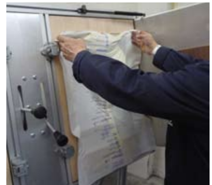
Étape 2 : l'opérateur place le sachet rempli de mousse dans le moule en bois.
