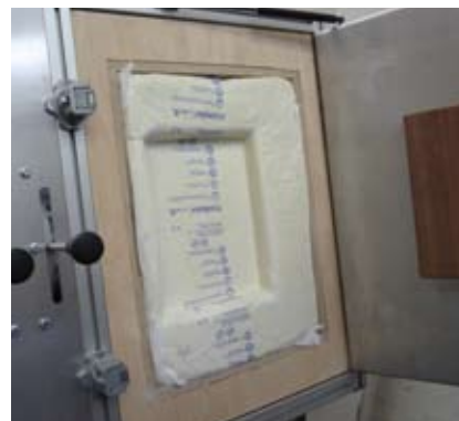
Étape 4 : après quelques secondes, le calage FOAMplus® est prêt.
