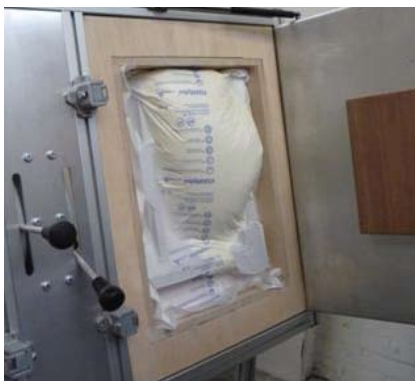
Étape 3 : le moule est fermé pour permettre l'expansion de la mousse.
