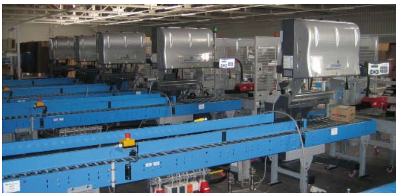
Plusieurs machines FOAMplus® Bagpacker intégrées dans un système de tapis roulants directs.
