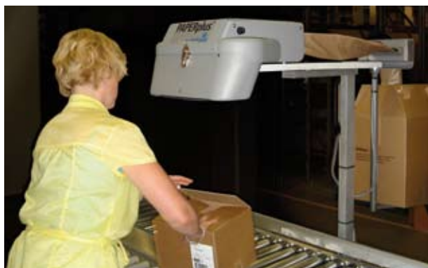
Une machine Shooter placée sur pivot pour surmonter les deux tapis roulants. La machine pivote pour permettre de changer le sac de papier.
