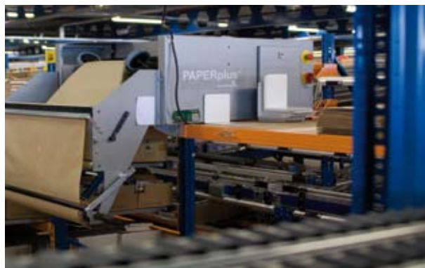
Une machine Classic intégrée dans un entrepôt de préparation de commandes de livres assistée par ordinateur.
