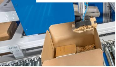
3. THE PROCESS OF INSERTING PROTECTIVE PACKAGING INTO THE BOX IS FULLY AUTOMATED
